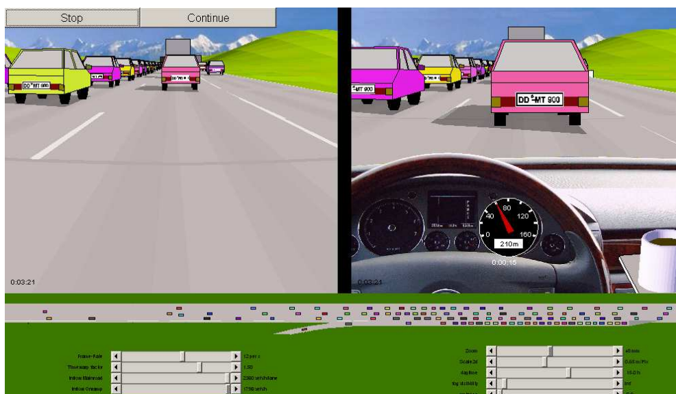
Abbildung 22: 3D-Simulator in der Fahrer und Vogelperspektive mit Einstellmöglichkeiten für verkehrliche und visuelle Parameter
