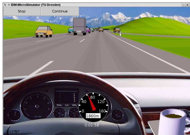
Abbildung 11: Der 3D-Fahrsimulator mit dem Coffeemeter zur Ruckmessung
