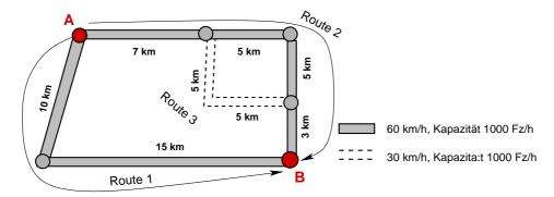
(a) Route 3 sei zunächst nicht aktiv. Legen Sie das verbleibende Netz in Abhängigkeit der normierten Nachfrage q = Q<sub>AB</sub>/K um, d.h. bestimmen Sie für das Nutzergleichgewicht den Anteil w<sub>1</sub>(q) der Fahrzeuge, welche Route 1 benutzen. Machen Sie ggf. eine Fallunterscheidung.
