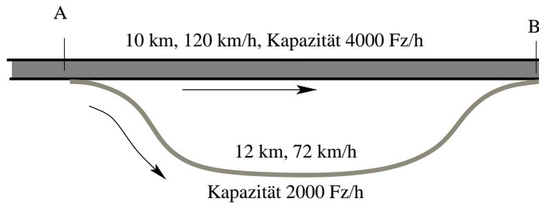
Die Reisezeiten auf jedem Routenabschnitt  $l$  in Abhängigkeit der Verkehrsbelastung  $Q_l$  und der Kapazität  $K_l$  werden durch quadratische CR-Funktionen der Form
