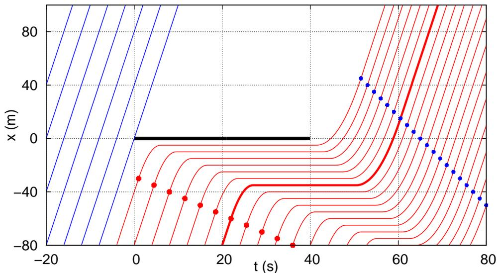
(a) Stopp an einer roten Ampel. Der dicke horizontale Strich stellt die Ampelposition zur Zeit der Rotphase dar.
