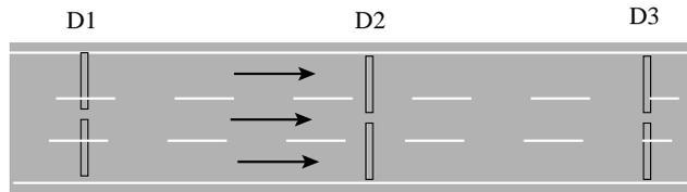
Die über alle Spuren summierten Verkehrsstärke bei D1 ist konstant =3600 Fz/h. Die Daten der beiden anderen Detektoren sind wie folgt (Alle Flusserte von 1800 Fz/h waren mit Gesamtdichten oberhalb 120 Fz/km verbunden):
