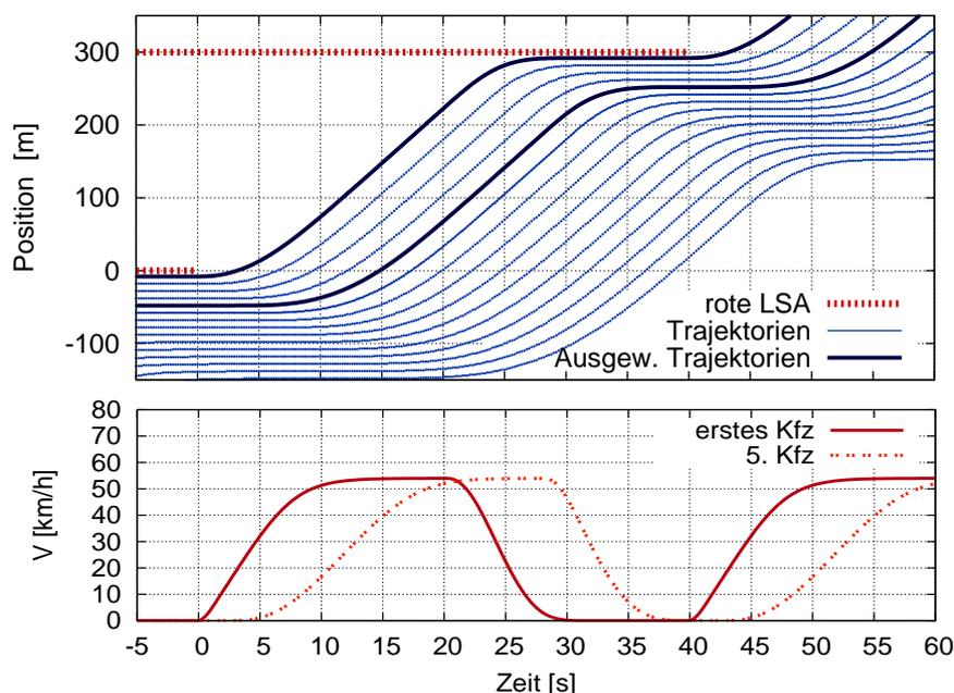
Das obere Teilbild stellt die Trajektorien aller 15 Fahrzeuge sowie (dick und horizontal) die Rotphasen von Ampeln dar. Unten sind die Geschwindigkeiten der beiden dicker gezeichneten Trajektorien dargestellt.
