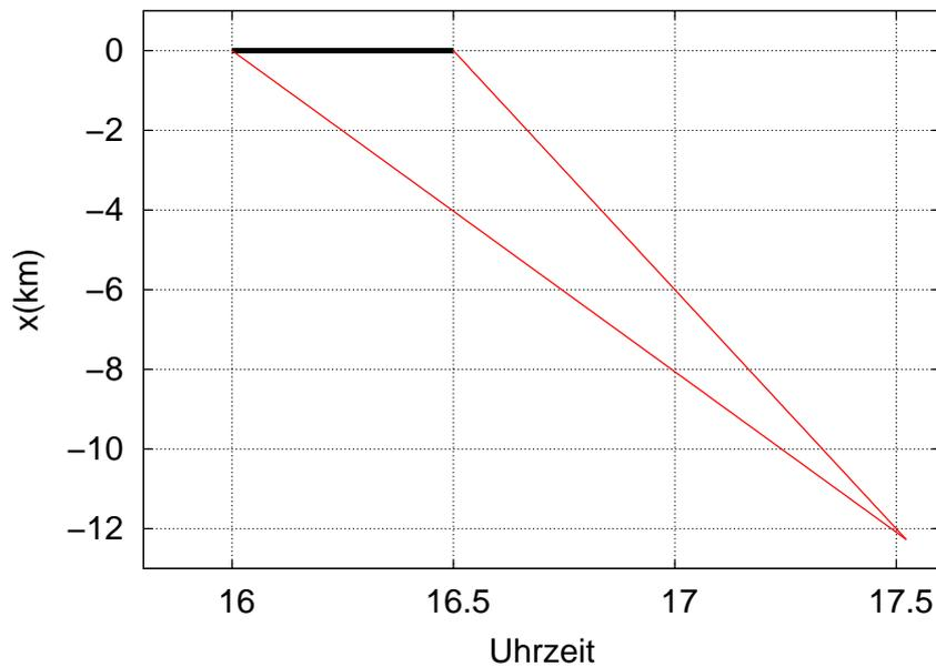
(e) Geben Sie die Trajektorie des Fahrzeugs an, welches durch diesen Stau maximal an Zeit verliert. Das ist die Trajektorie, welche um 16:00 den Punkt  $x = 0$  der beginnenden Vollsperrung erreicht. Dieses Fahrzeug muss 30 min warten.
