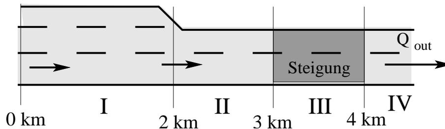
Wegen hohen LKW-Aufkommens ist die mittlere freie Geschwindigkeit im Bereich der Steigung nur  $v_{02} = 60$  km/h, während davor und danach  $v_{01} = 120$  km/h gilt. Die Folgezeit wird im Bereich der Steigung von  $T_1 = 1.5$  s auf  $T_2 = 1.9$  s erhöht. Die mittlere Länge einschließlich Mindestabstand beträgt  $l = 10$  m. Das Fahrverhalten wird gemäß dem Lighthill-Whitham-Modell mit folgender Geschwindigkeitsrelation modelliert:
